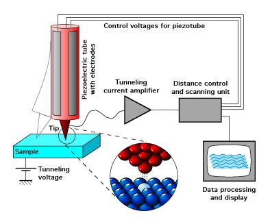
FIGURE 1 – Schéma simplifié d'un microscope à effet tunnel. Lorsqu'une différence de potentiel est exercée entre une pointe (*tip*) et une surface métalique (*sample*), un courant peut circuler même si la pointe et le métal sont séparés par du vide. Figure issue du site internet de l'Institut de Physique Appliquée de l'université technique de Vienne TU WIEN.
