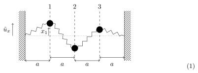
Chacune des masses peut glisser verticalement le long d'une tige rigide, et elles sont séparées les unes des autres d'une distance a beaucoup plus grande que la longueur au repos des ressorts,  $L_0$ . On numérote en ordre les masses de 1 à 3, de gauche à droite, et on note  $x_n$  la hauteur de la masse numéro n par rapport à sa position d'équilibre (on néglige les effets de la gravité). On suppose de plus que chaque masse subit une force de frottement  $-M\gamma\dot{x}_n\hat{u}_x$ .
