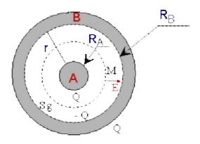
Question 9 (1 point) Dans la base de coordonnées sphériques, le vecteur champ électrostatique  $\overrightarrow{E}$  en un point M situé entre les armatures vaut :
