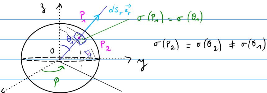
$$Q = \iint_{\text{sphère}} \sigma(\theta) dS_r \quad \text{avec : } d\vec{OM} = \begin{pmatrix} dr \\ r d\theta \\ r \sin\theta d\varphi \end{pmatrix}$$
